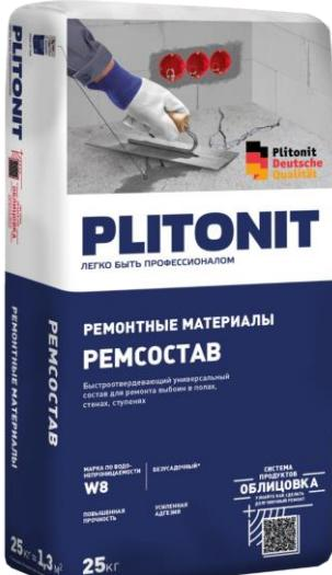
Продукт предназначен для ремонта и выравнивания вертикальных и горизонтальных поверхностей из бетона, железобетона, кирпича при производстве внутренних и наружных работ. Рекомендуемая толщина слоя при выравнивании от 5 до 50 мм (в углублениях до 80 мм). Температура покрытия в процессе эксплуатации – до +70°C. Максимальная фракция заполнителя – 2,5 мм.
