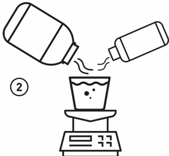
**2** Отмерьте все три компонента в ёмкость для смешивания. Соблюдайте пропорцию, рекомендованную производителем. Порядок дозирования компонентов не имеет значения. В случае, если продукт подвергался замораживанию, его использование допускается не ранее, чем после выдерживания в течение 24 часов при комнатной температуре от +10°C до +25°C. Нагревание с целью более раннего оттаивания не допускается.
