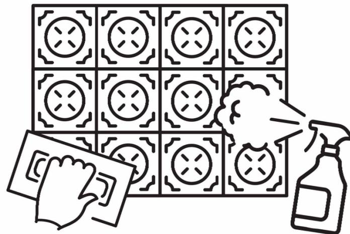
Остатки эпоксидного налёта удаляются при помощи тёплой воды в течение 24 часов после затирки швов. В дальнейшем эпоксидный налёт можно устранить при помощи удалителя эпоксидного налёта PLITONIT. Рекомендуем проверить работу средства на тестовом участке чтобы убедиться, что средство не меняет цвет плитки
