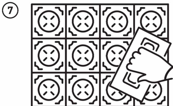
**7** Диагональными движениями шпателя уберите с поверхности плитки излишки затирки. Используйте в качестве рабочей длинную кромку.
