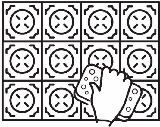
Замойте поверхность при помощи хорошо отжатой целлюлозной губки. Мы рекомендуем работать с минимальным нажимом и часто промывать губку в ёмкости с чистой водой.
