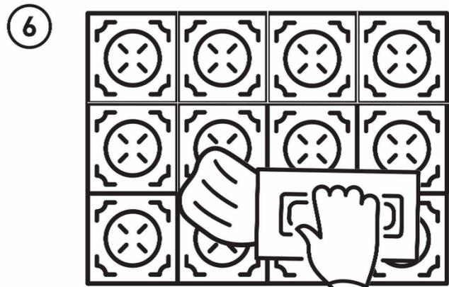
**6** Заполните швы эпоксидной затиркой при помощи резинового шпателя. Используйте для работы короткую кромку.
