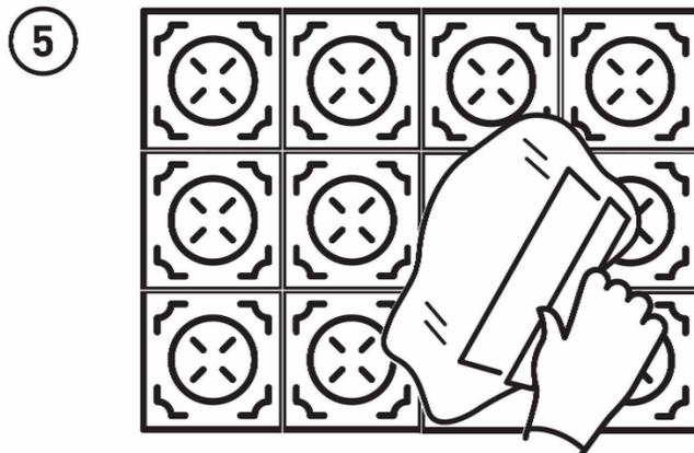
**5** С помощью стального шпателя или любого удобного для Вас инструмента выложите приготовленную смесь на плиточную облицовку, швы которой предстоит затереть. При работе с натуральным камнем или материалом с открытыми порами (например, с полированным керамогранитом) необходимо выполнить пробную затирку, чтобы убедиться, что цвет плитки не изменяется.
