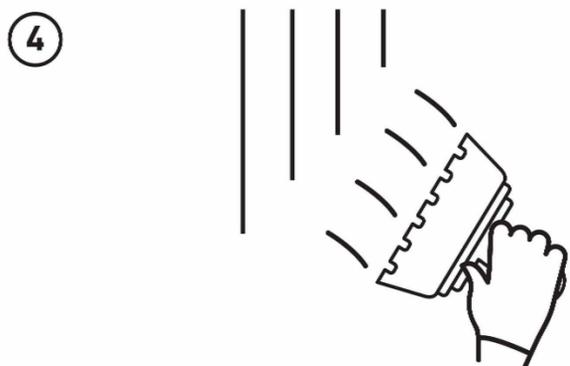
**4** При работе с тонкой или прозрачной плиткой важно, чтобы цвет клея не отличался от цвета затирки. Рекомендуем применять Colorit EasyFill в качестве плиточного клея. Жизнеспособность материала - не менее 90 минут при температуре от +20 °C до +25 °C
