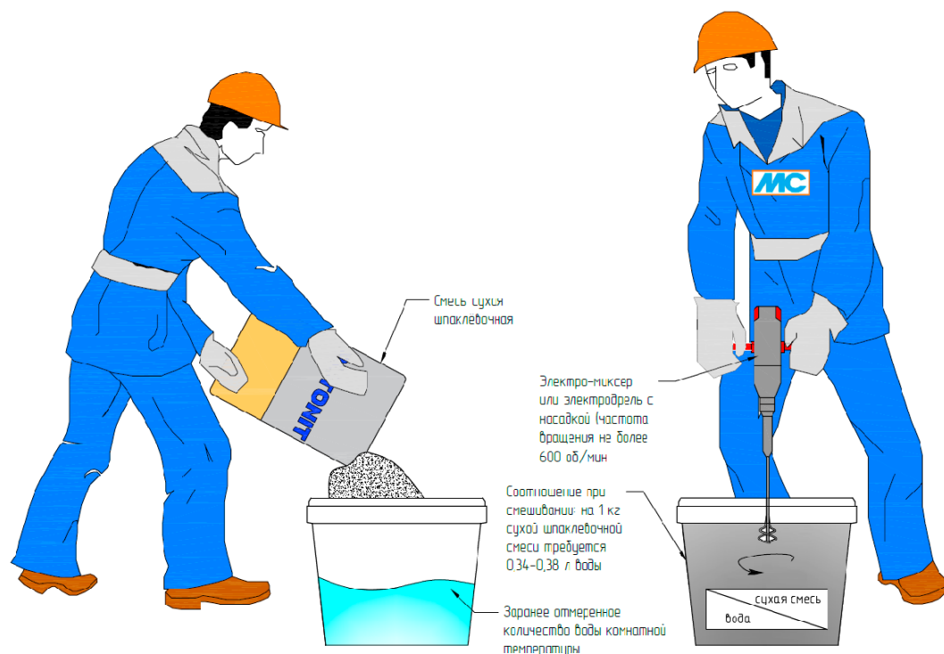
Рис. 28. Организация работ по затворению сухой шпаклевочной смеси
