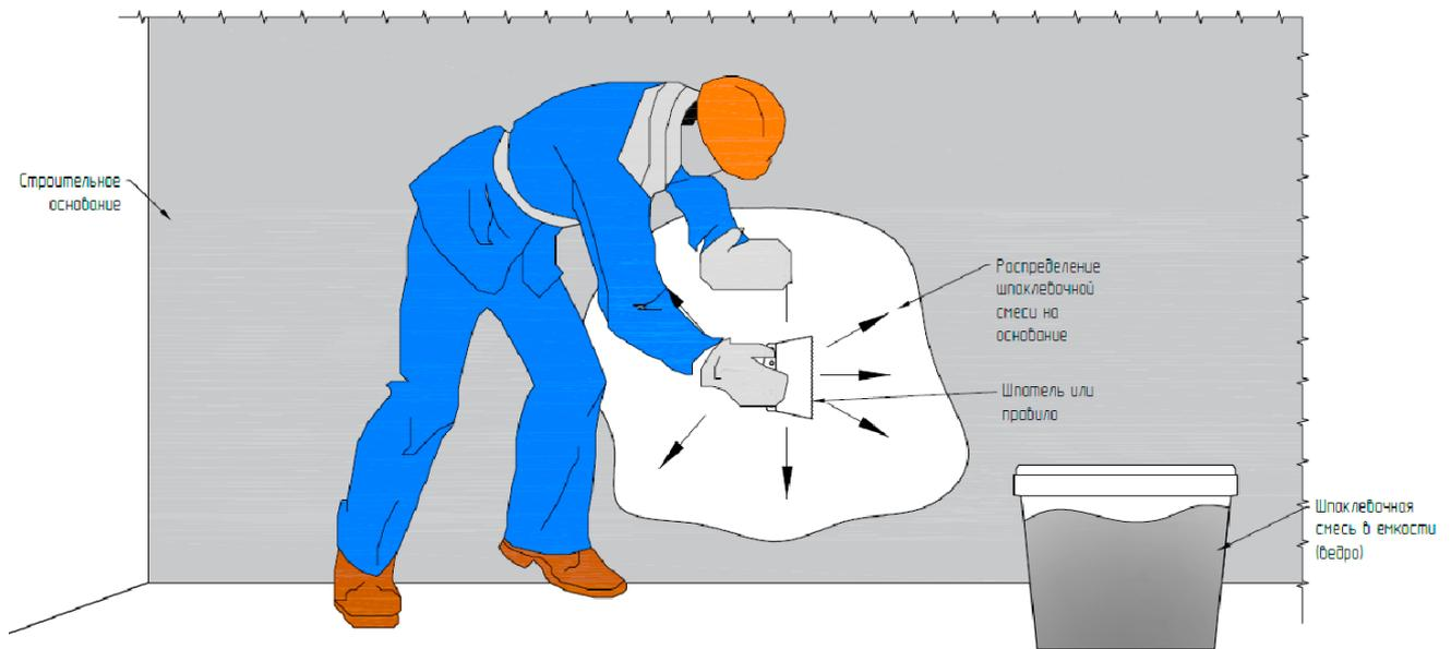
Рис. 14. Организация работ по нанесению шпаклевочной смеси
