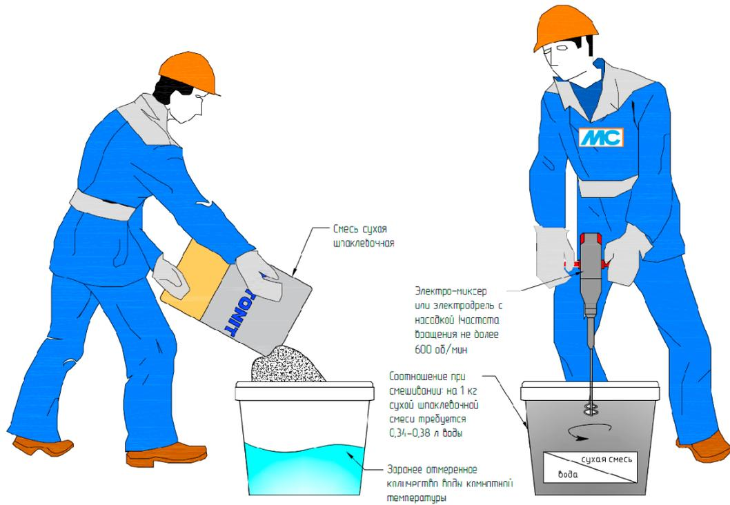
Рис. 13. Организация работ по затворению сухой шпаклевочной смеси
