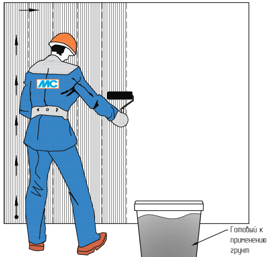
Рис. 17. Схема организации работ по нанесению грунта на основание
