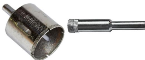
Рис.22. Алмазная коронка и сверло для устройства отверстий.
