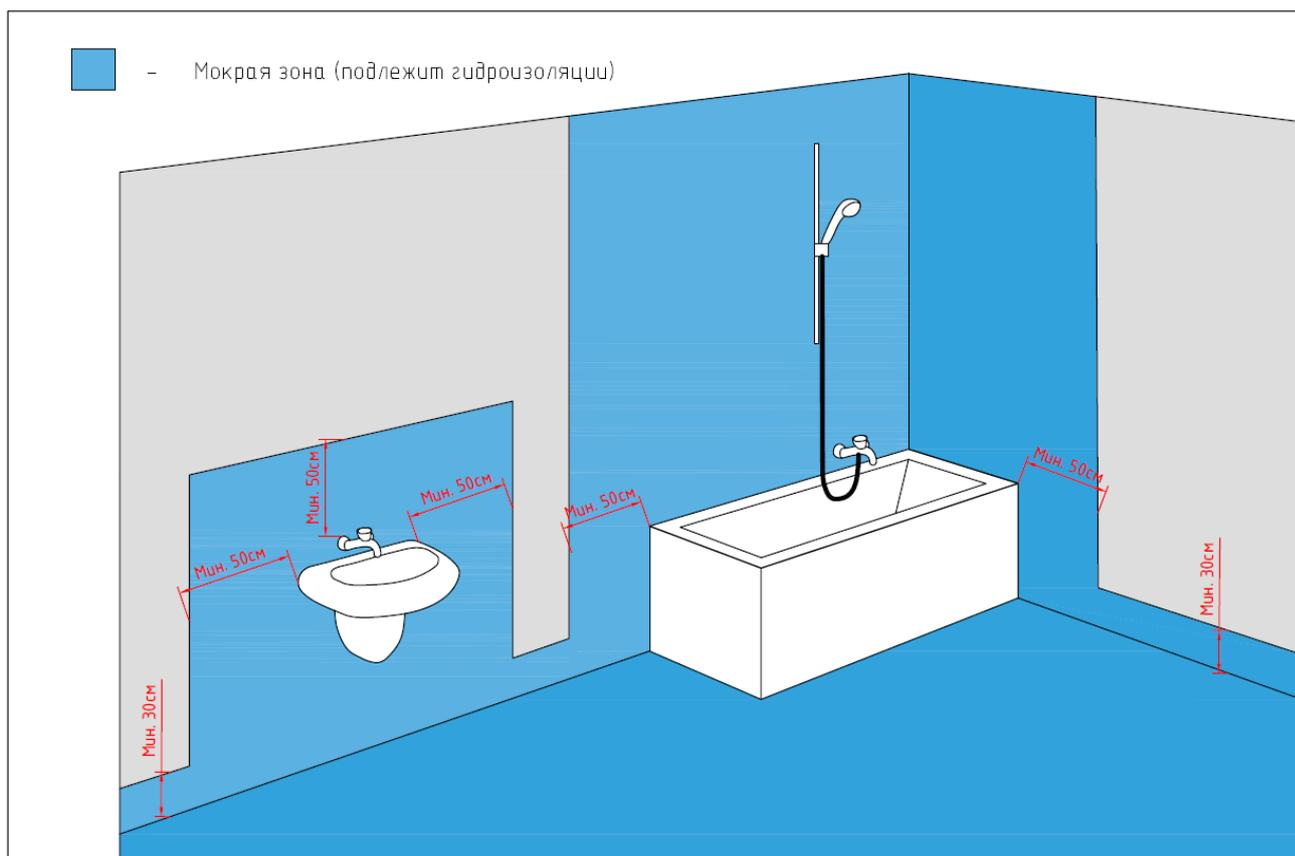
Рис. 14.2 Мокрые зоны внутри влажных помещений, подлежащие гидроизоляции.
