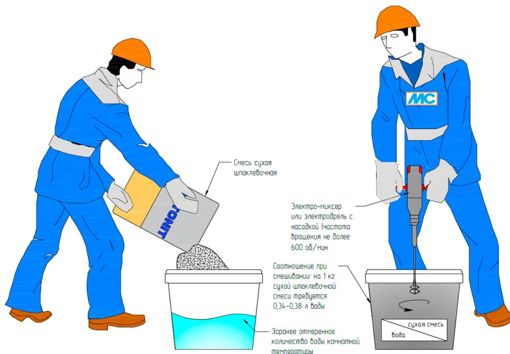
Рис. 15. Организация работ по затворению сухой шпаклевочной смеси
