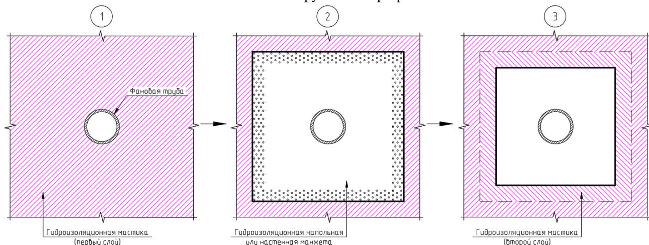
Рис.13.4. Последовательность нанесения гидроизоляционной манжеты
