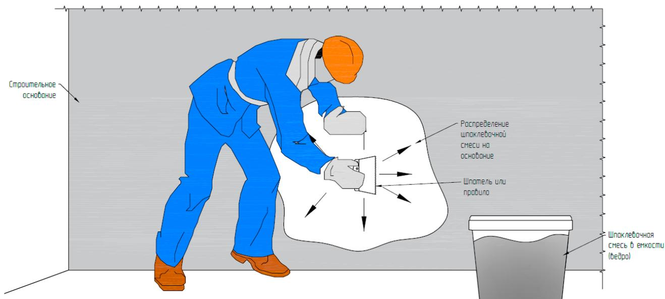
Рис. 16. Организация работ по нанесению шпаклевочной смеси
