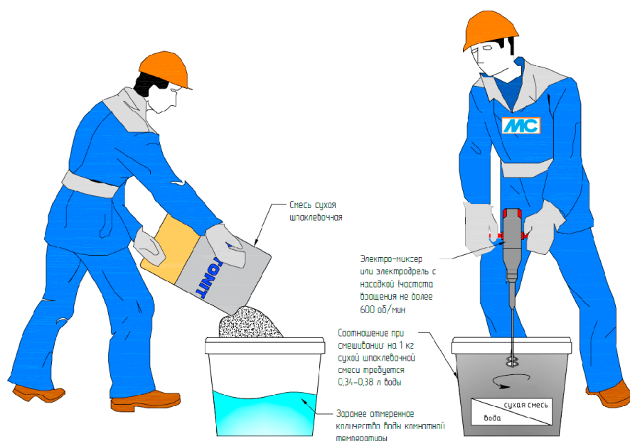
Рис. 26. Организация работ по затворению сухой шпаклевочной смеси
