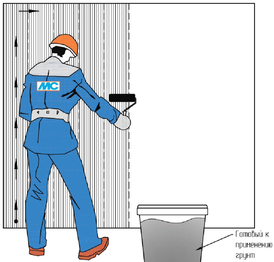
Рис. 23. Схема организации работ по нанесению грунта на основание
