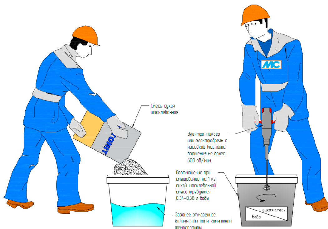
Рис. 6. Организация работ по затворению сухой шпаклевочной смеси
