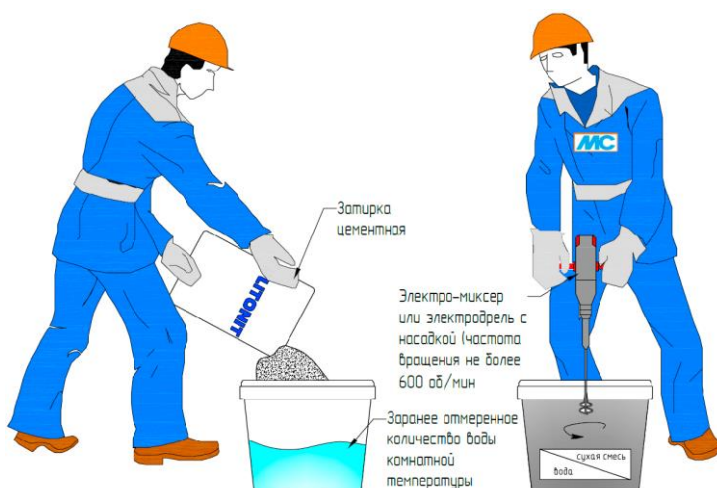
Рис. 38. Приготовление состава
