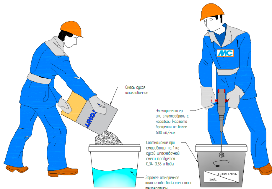
Рис. 17. Организация работ по затворению сухой шпаклевочной смеси
