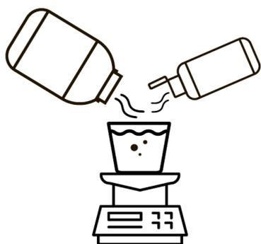
Отмерить все три компонента в ёмкость для смешивания. Соблюдать пропорцию, рекомендованную производителем. Порядок дозирования компонентов не имеет значения. В случае, если продукт подвергался замораживанию, его использование допускается не ранее, чем после выдерживания в течение 24 часов при комнатной температуре от +10°С до +25°С. Нагревание с целью более раннего оттаивания не допускается.
