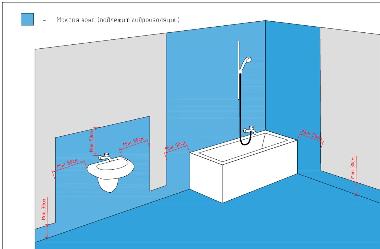
Рис. 17.2 Мокрая зона внутри влажных помещений, подлежащие гидроизоляции.
