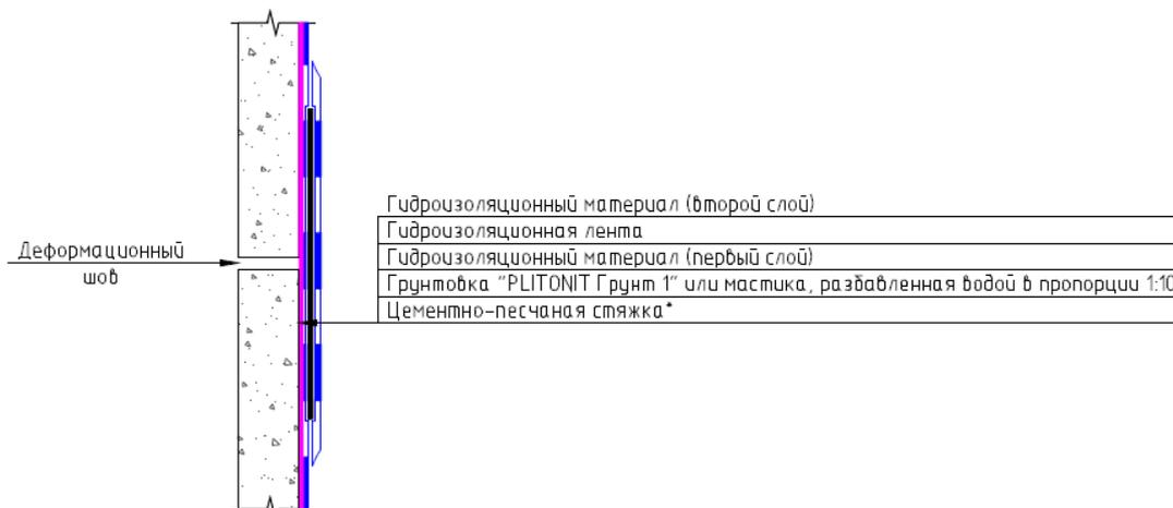
Рис.16.3. Конструктивный разрез №3.
