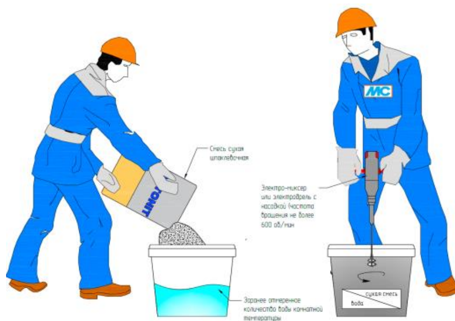
Рис. 14. Организация работ по затворению сухой шпаклевочной смеси
