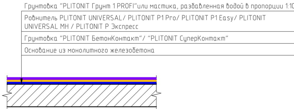
Рис.28. Конструктивный разрез №3.
