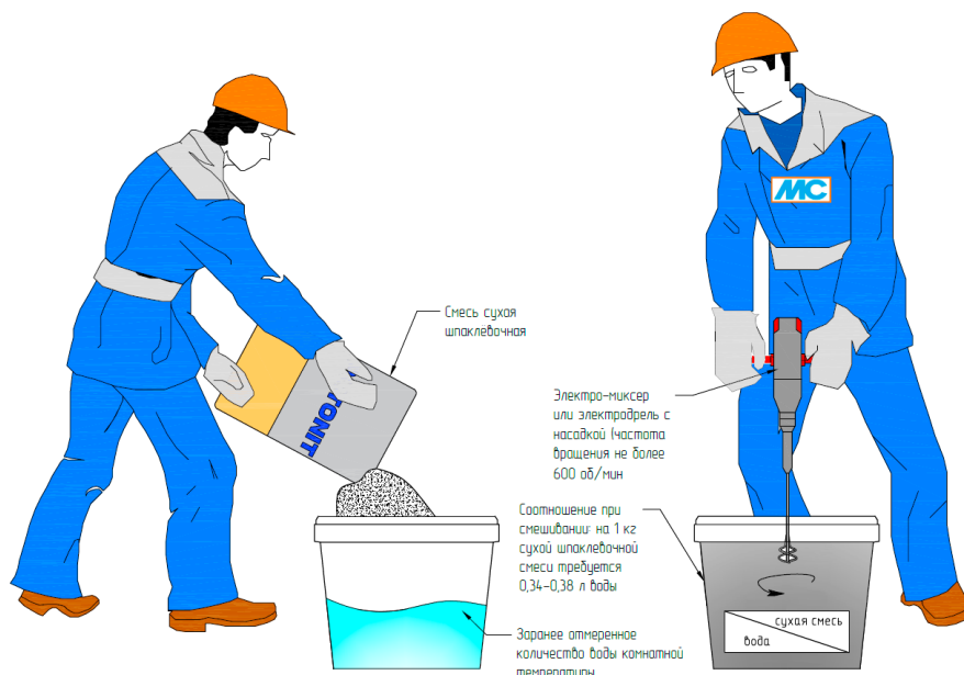
Рис. 27. Организация работ по затворению сухой шпаклевочной смеси
