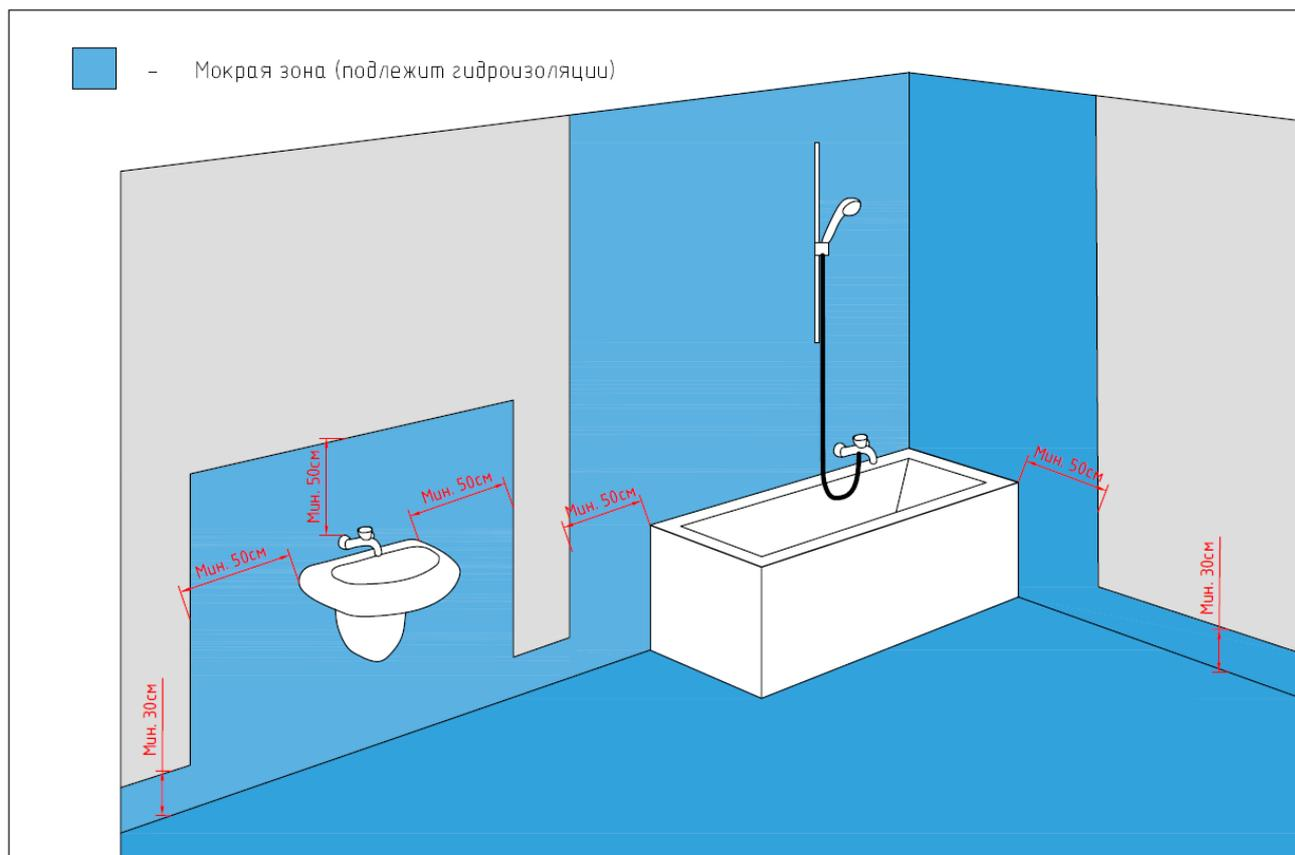
Рис. 9.2 Мокрые зоны внутри влажных помещений, подлежащие гидроизоляции.
