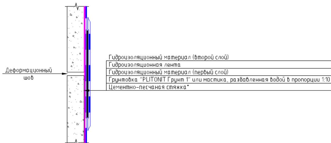
Рис.8.3. Конструктивный разрез №3ф.
