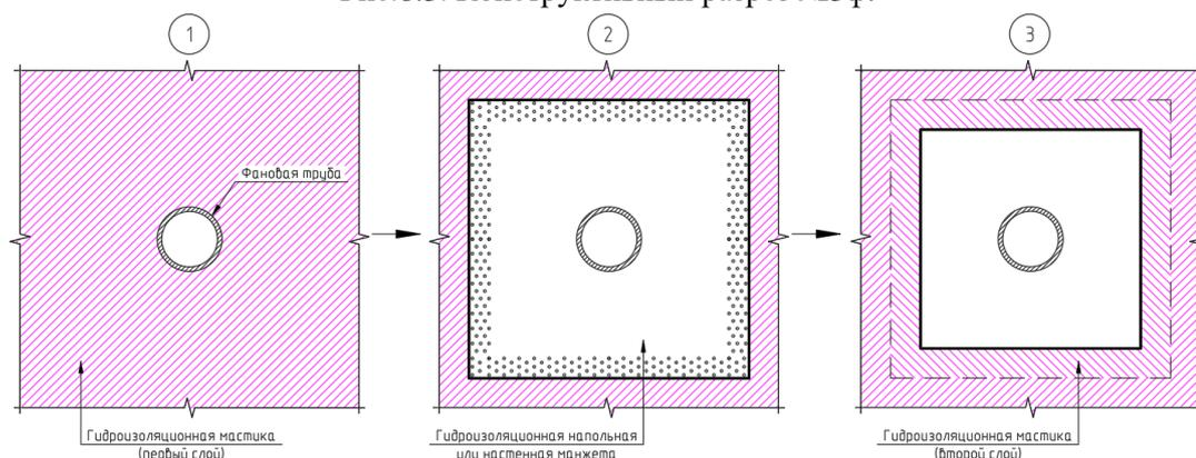
Рис.8.4. Последовательность нанесения гидроизоляционной манжеты.
