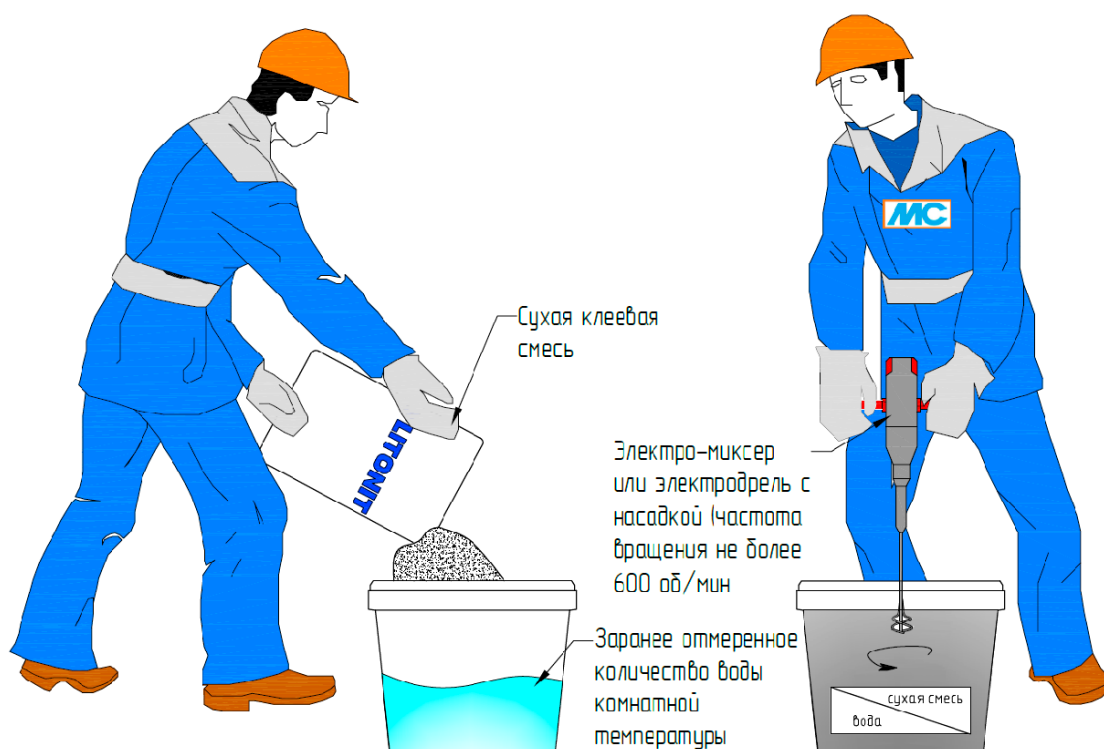
Рис. 8. Организация работ по затворению сухой клеевой смеси
