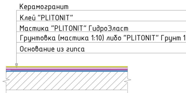
Сечение готового покрытия.
