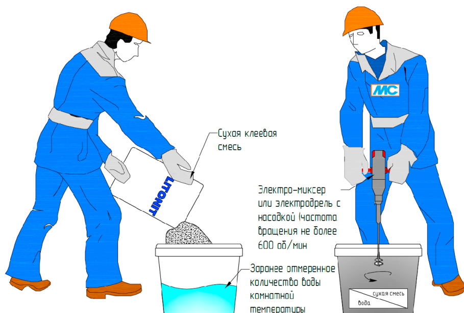
Рис. 15. Организация работ по затворению сухой клеевой смеси
