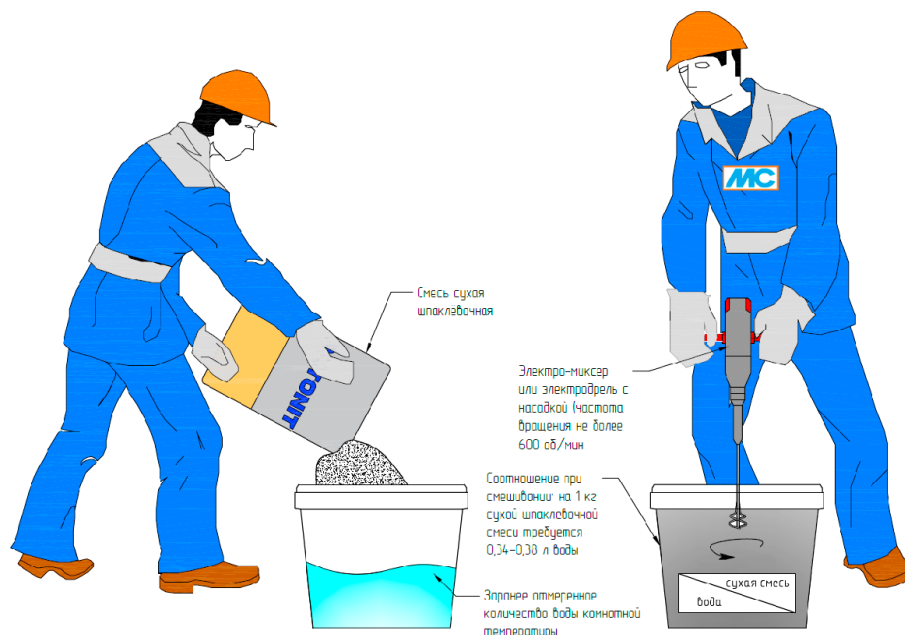
Рис. 24. Организация работ по затворению сухой шпаклевочной смеси
