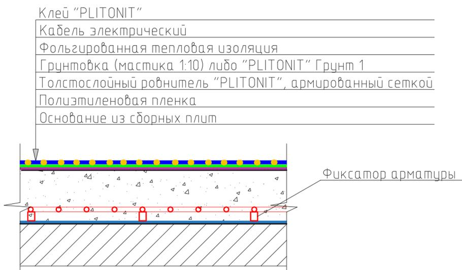
Рис.40. Конструктивный разрез №9.
