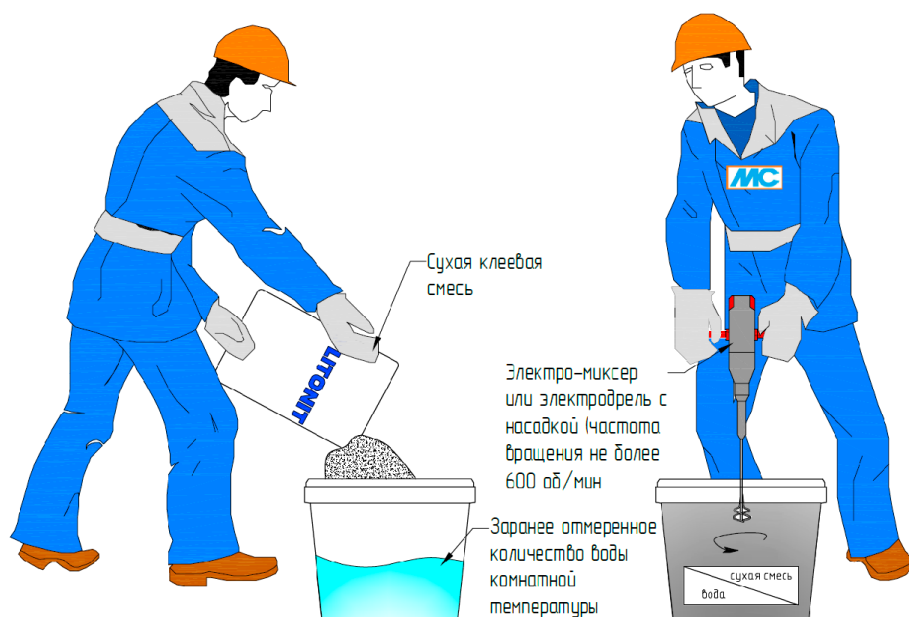
Рис. 25. Организация работ по затворению сухой клеевой смеси
