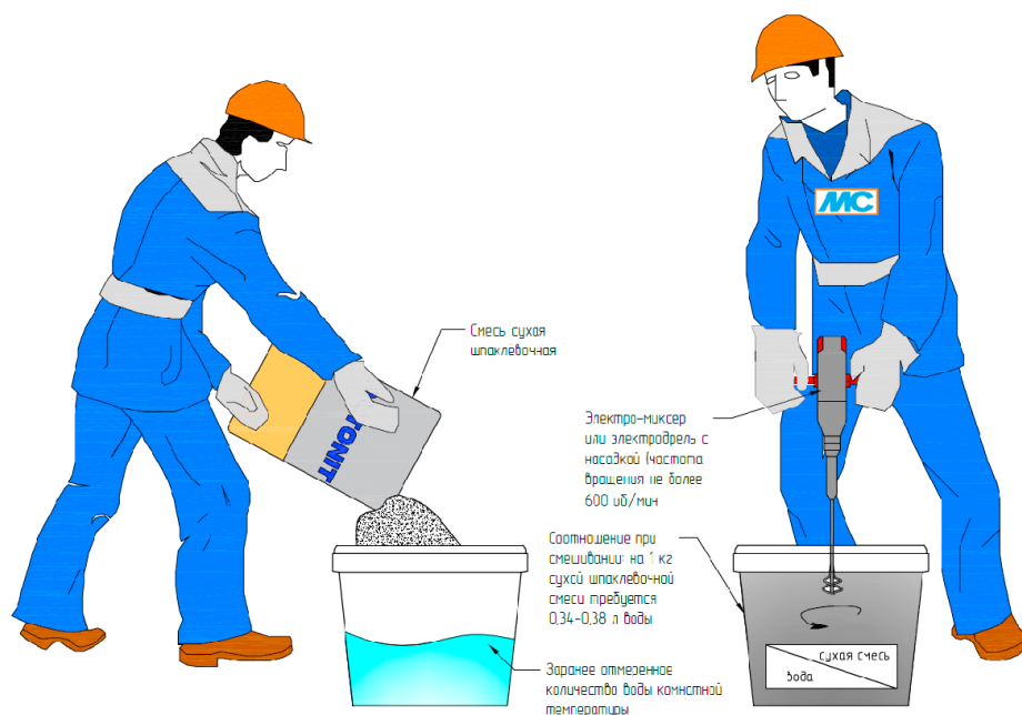
Рис. 23. Организация работ по затворению сухой шпаклевочной смеси
