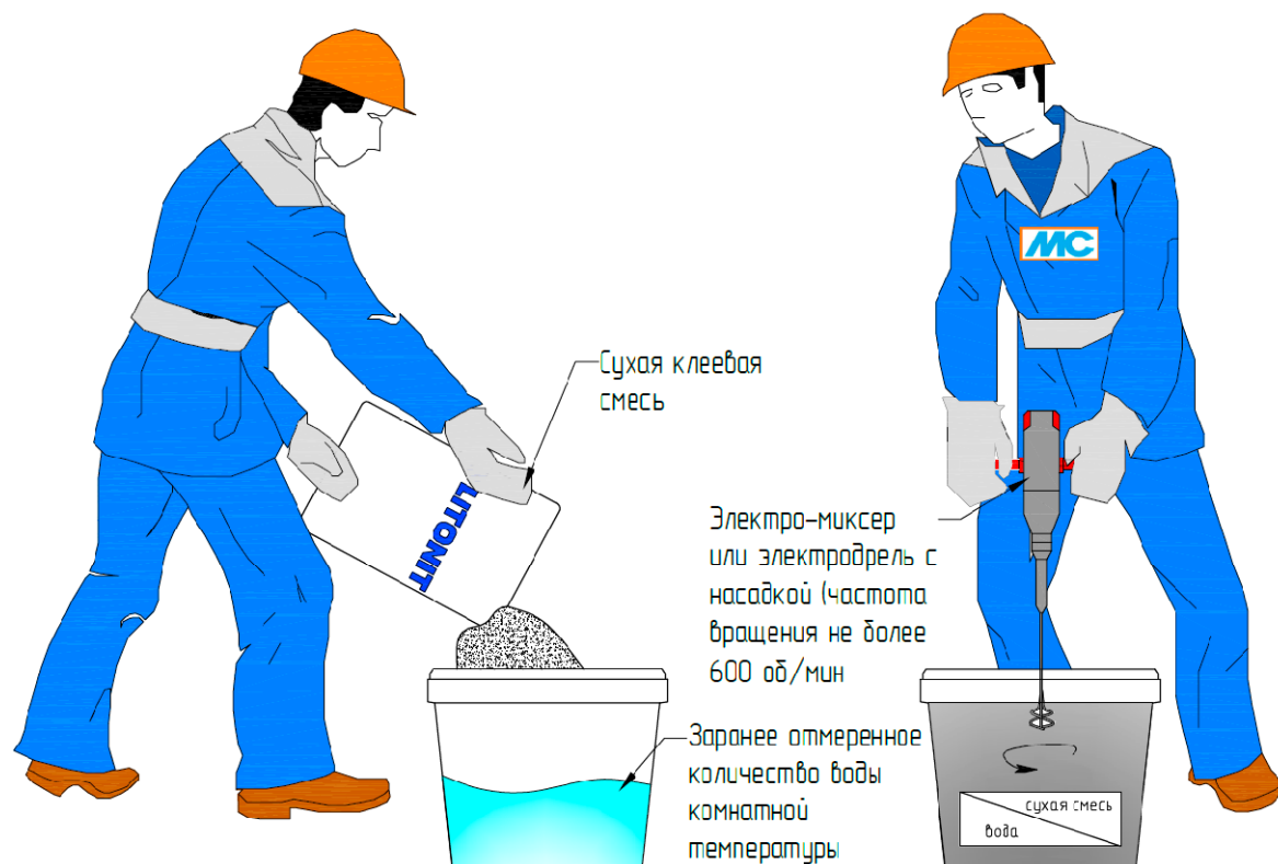
Рис. 29. Организация работ по затворению сухой клеевой смеси
