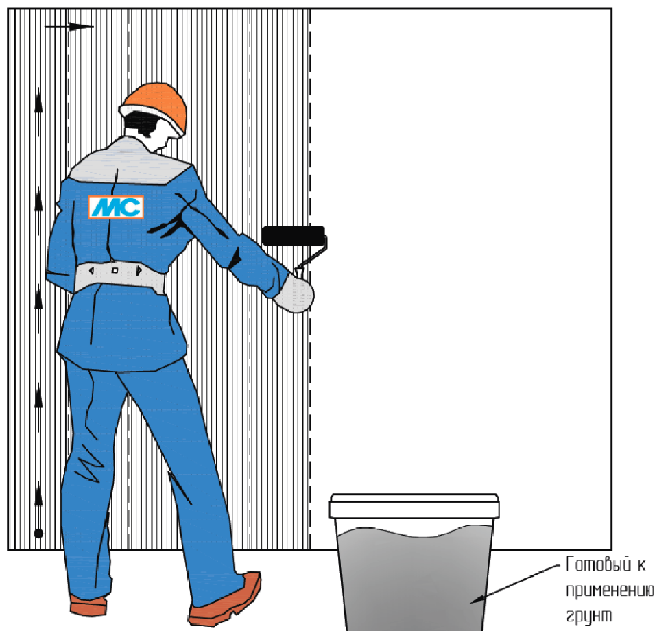
Рис. 26. Схема организации работ по нанесению грунта на основание
