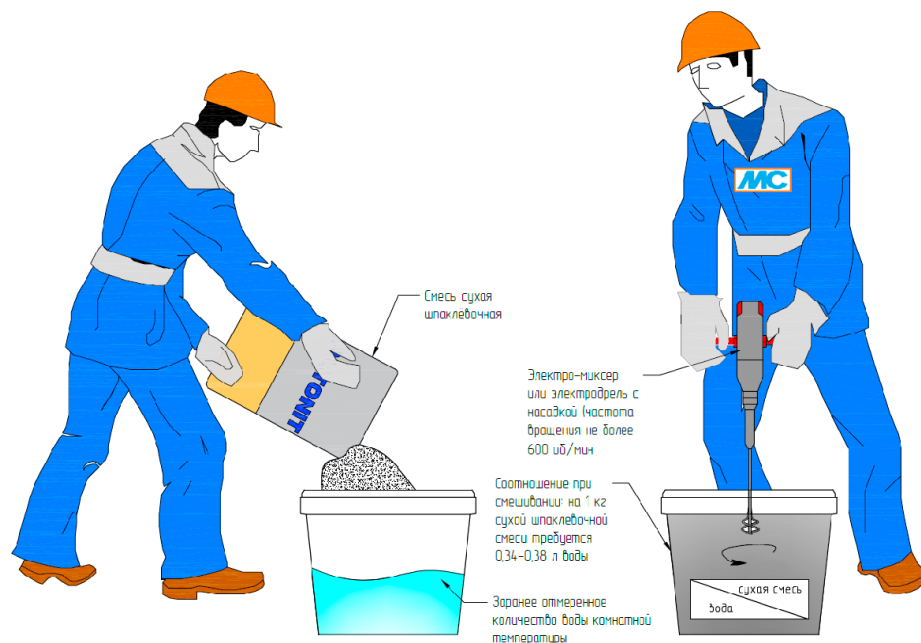
Рис. 27. Организация работ по затворению сухой шпаклевочной смеси
