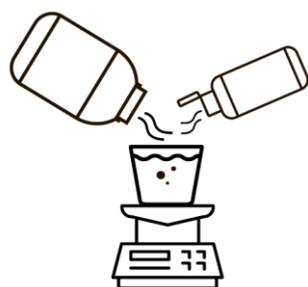
Отмерить все три компонента в ёмкость для смешивания. Соблюдать пропорцию, рекомендованную производителем. Порядок дозирования компонентов не имеет значения. В случае, если продукт подвергался замораживанию, его использование допускается не ранее, чем после выдерживания в течение 24 часов при комнатной температуре от +10°C до +25°C. Нагревание с целью более раннего оттаивания не допускается.
