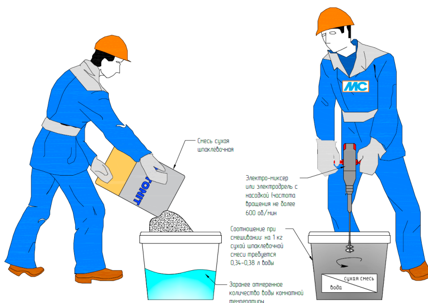
Рис. 27. Организация работ по затворению сухой шпаклевочной смеси
