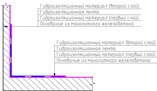
Рис.28. Устройство гидроизоляции внутренних углов с применением «PLITONIT ГидроЛента» и «PLITONIT ГидроЛента угол внутренний 90°».
