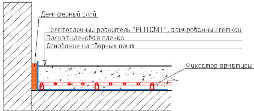
Рис.25. Конструктивный разрез №1.
