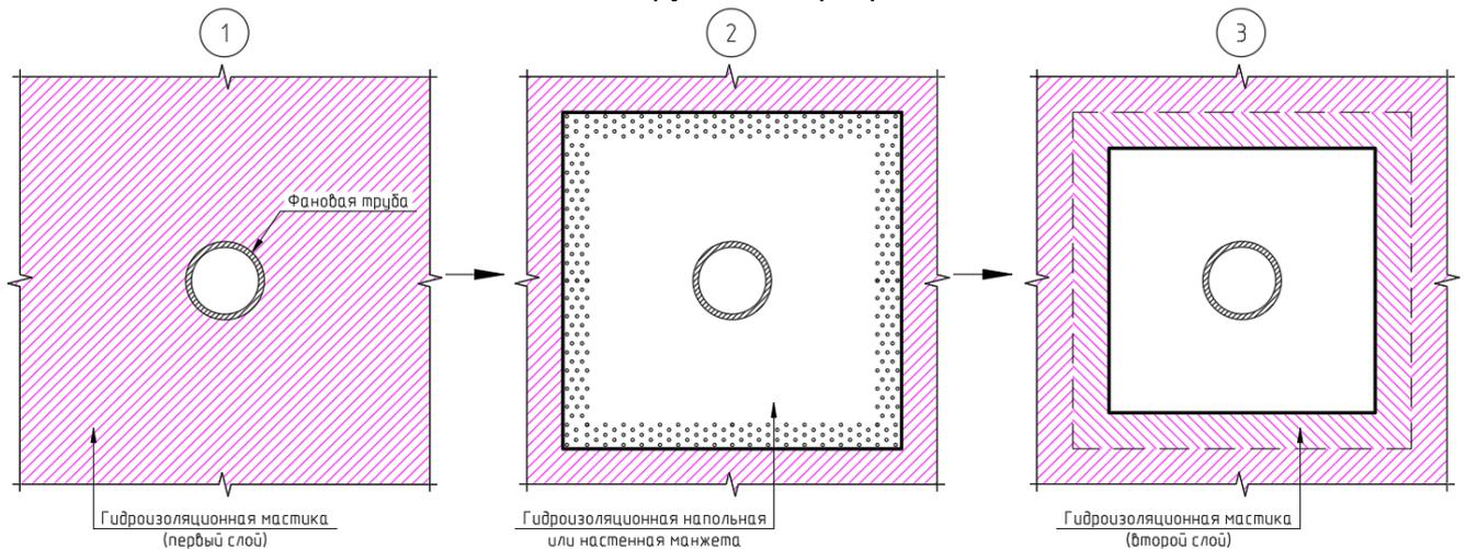
Рис.32. Последовательность нанесения гидроизоляционной манжеты.
