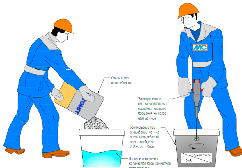
Рис. 20. Организация работ по затворению сухой шпаклевочной смеси
