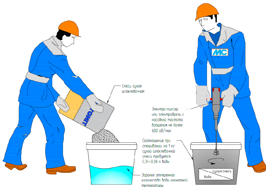
Рис. 17. Организация работ по затворению сухой шпаклевочной смеси
