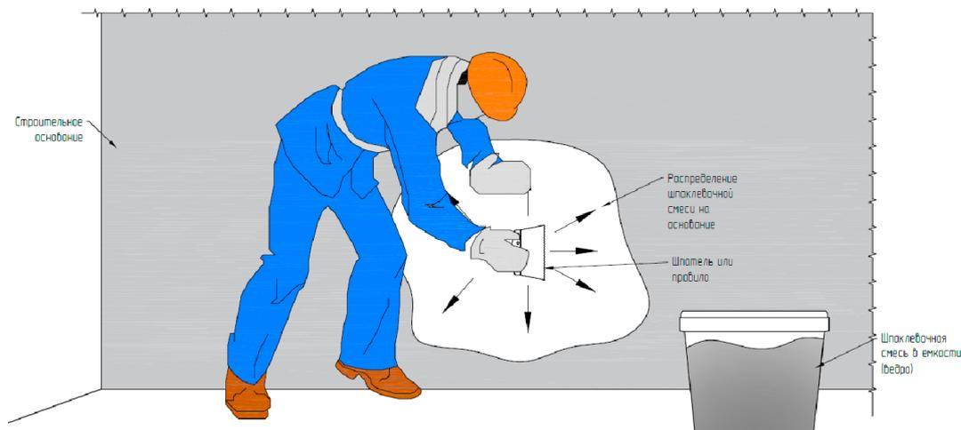
Рис. 25. Организация работ по нанесению шпаклевочной смеси
