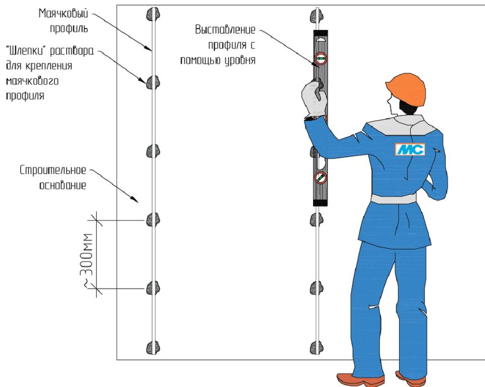
Рис.14. Монтаж маяка с помощью правила с уровнем
