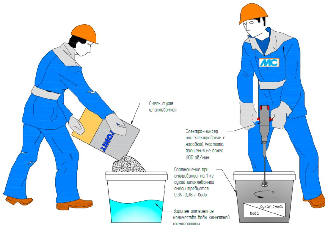
Рис. 24. Организация работ по затворению сухой шпаклевочной смеси
