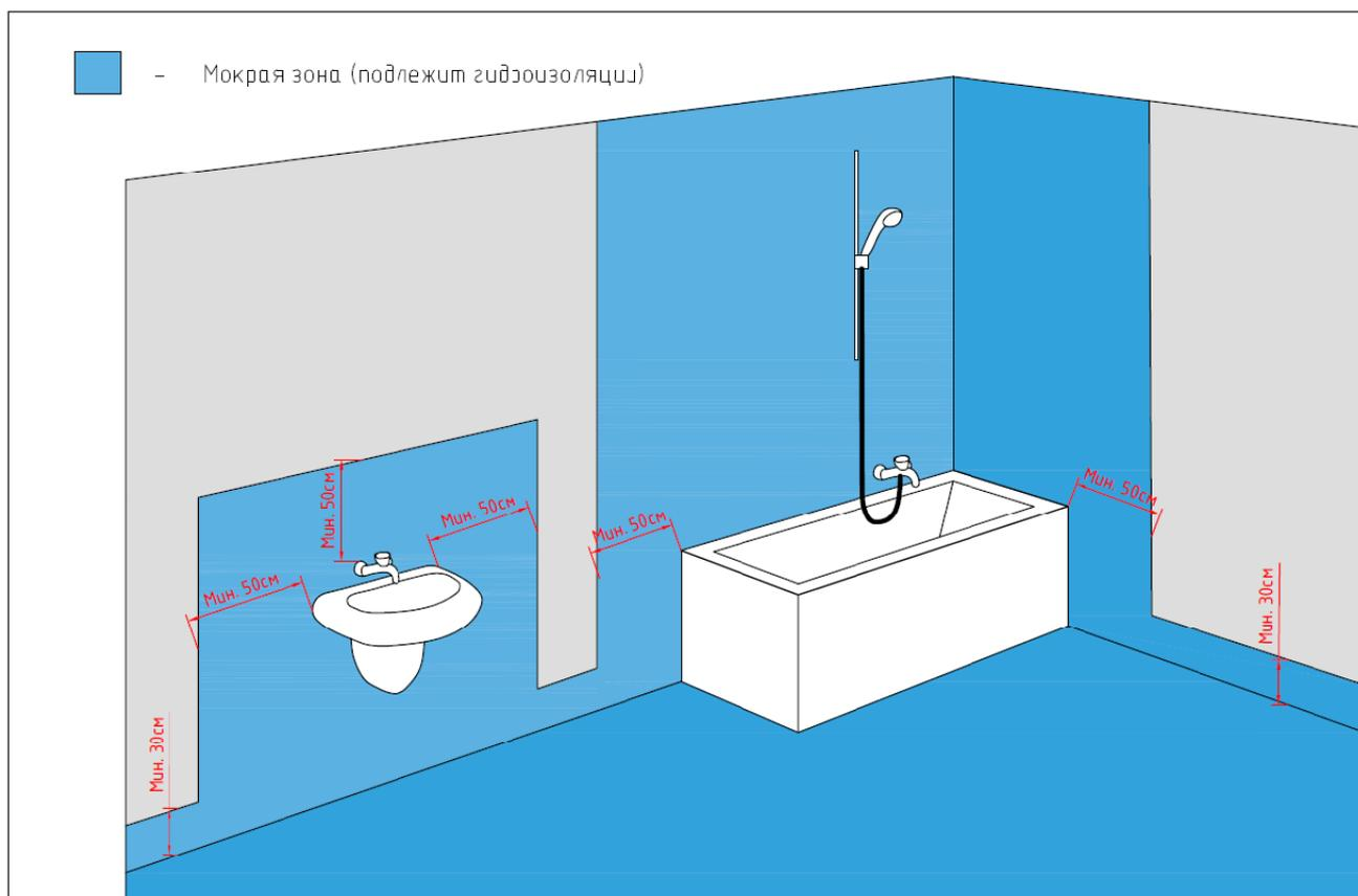
Рис. 23.2 Мокрые зоны внутри влажных помещений, подлежащие гидроизоляции.
